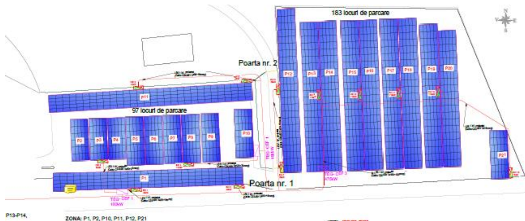
Fig. 58.A. Instalare panouri fotovoltaice – locație 1
